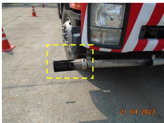
ภาพที่ 2.1-17 อุปกรณ์ป้องกันการเกิดประกายไฟ จากท่อไอเสียเครื่องยนต์
